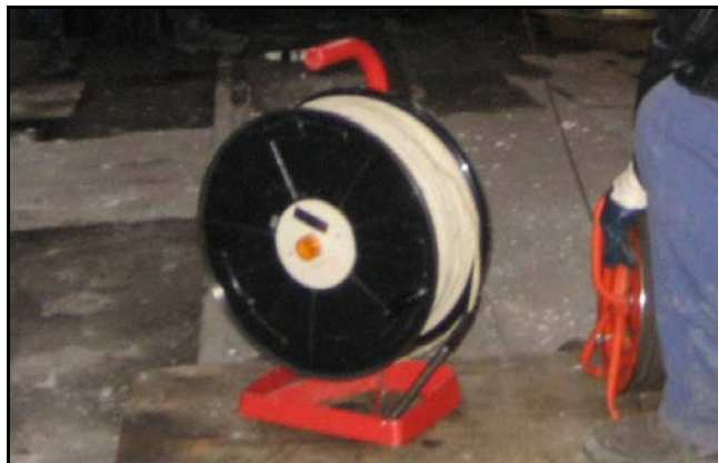
Fotografía 12-1.- Medidor de hidronivel marca Seba
