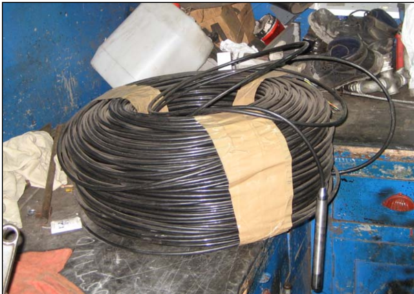
Fotografía 12-2.- Sonda FMX-167 de 22 mm de diámetro exterior
